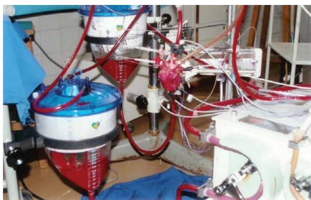
Fig. 2 - Visão geral do coração isolado perfundido. Coração isolado com minipinça metálica para indução da isquemia regional. Reservatório AE, funcionando como reservatório de pré-carga. Reservatório venoso de onde o sangue era reinfundido para o animal suporte. Linha aferente ao animal suporte da bomba de roletes. Fios dos cristais piezoelétricos.
